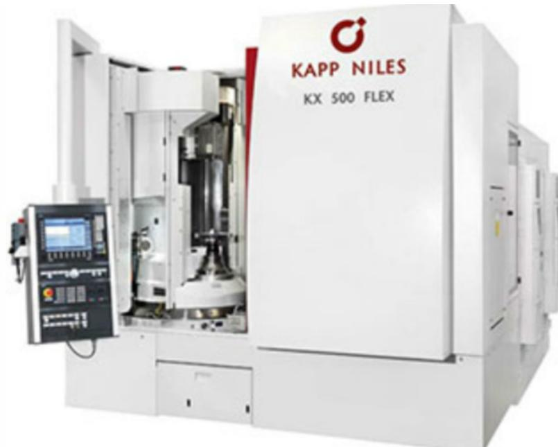
德国磨齿机长时间不用时应将机床按规定封存起来。应将数控系统的内部和外部清洁干净，套上防护罩，切断电源。若CNC系统处在长期闲置的情况下，需要经常给系统通电，特别是在环境湿度较大的梅雨季节更是如此。日检其主要项目包括液压系统、主轴润。保养有很多的，有简单清洁保养等，如机床表面上的罩板清洁保养，防生锈、磨损漏水电柜散热类清洁，如散热风扇、滤网的清洁机械润滑类保养，检查机械润滑是否正常，是否有漏油与堵塞现象，定期清理润滑油箱等。
